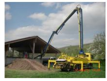
Rührt und homogenisiert effizient Gülle, Gärreste und andere Flüssigkeiten. Schwimm- und Sinkschichten werden durch den 80 cm großen Rotor wirkungsvoll aufgelöst.
